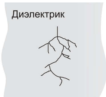
Рис.5 Дендритный рост газовых включений
