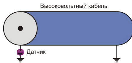
Рис.4 Регистрация Частичных Разрядов в кабельной линии
